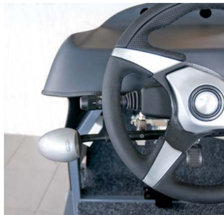
Controle manual montado no volante para o acelerador e para o freio.
