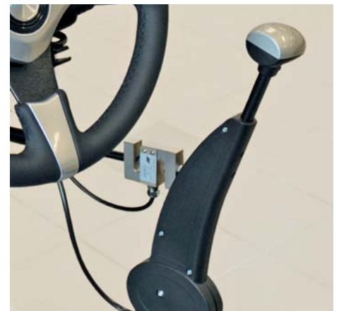
Controle manual montado no assoalho para o acelerador e para o freio.
