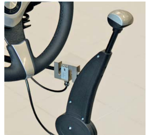
Commande manuelle montée au sol pour le contrôle de l'accélérateur et du frein.
