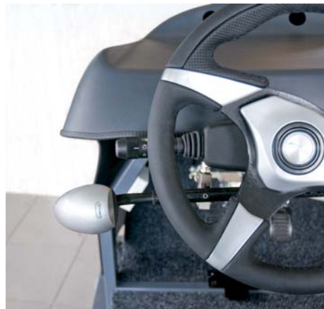
Commande manuelle montée sur le volant pour le contrôle de l'accélérateur et du frein.
