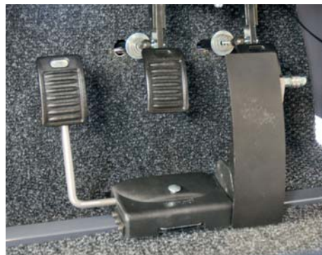
L'adaptateur pour la pédale d'accélérateur du côté gauche est montée sur le plancher.
