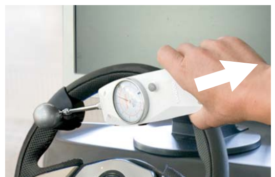
Mesure de l'inertie du volant.
