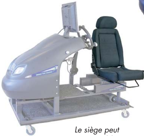
La plate-forme du siège peut être retirée pour accueillir une personne assise dans un fauteuil roulant.
