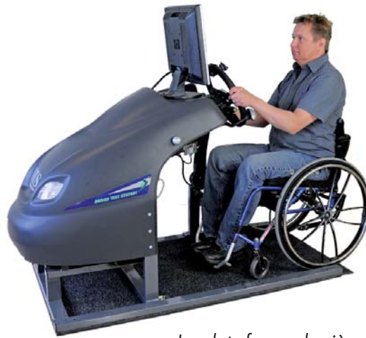
La plate-forme du siège peut être retirée pour accueillir une personne assise dans un fauteuil roulant.
